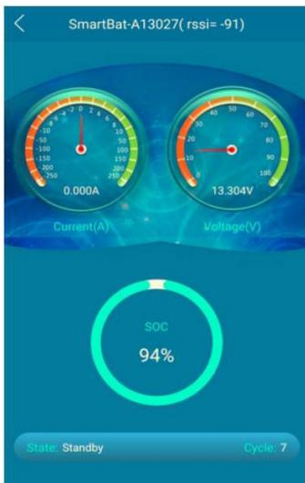
1ª pantalla. Estos datos son los más relevantes para el uso normal. Indica la corriente en amp que está cargando o descargando en ese momento, el voltaje de la batería, la capacidad restante en % y el número de ciclos utilizado (la batería nueva viene con 2 ciclos en origen).
