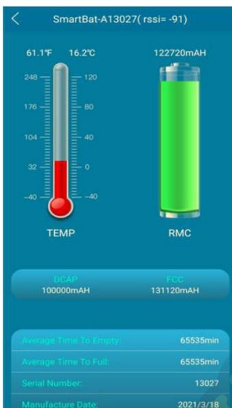
2ª pantalla. Temperatura de la batería. DCAP (Design Capacity) capacidad de la batería (nominal). RMC (Remaining Capacity). Capacidad restante. FCC (Full Charge Capacity) Capacidad de la batería al 100%. Estos dos últimos parámetros pueden sufrir oscilaciones importantes en función de la temperatura ambiente y requieren de historial de cargas y descargas de la batería.
